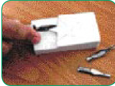
شكل ( ١٦ ، ب ) الحفر حول التصميم بالأدوات الخاصة
